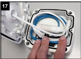
Verkabelung vollständig in die Anschlussbox legen.
