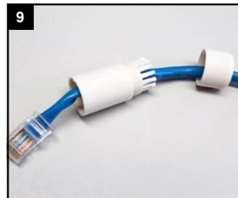
Verschraubung und Schraub-bolzen über das Kabel ziehen.
