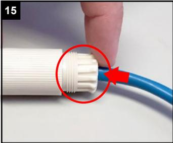
Dichtung in den Schraubbolzen pressen.
